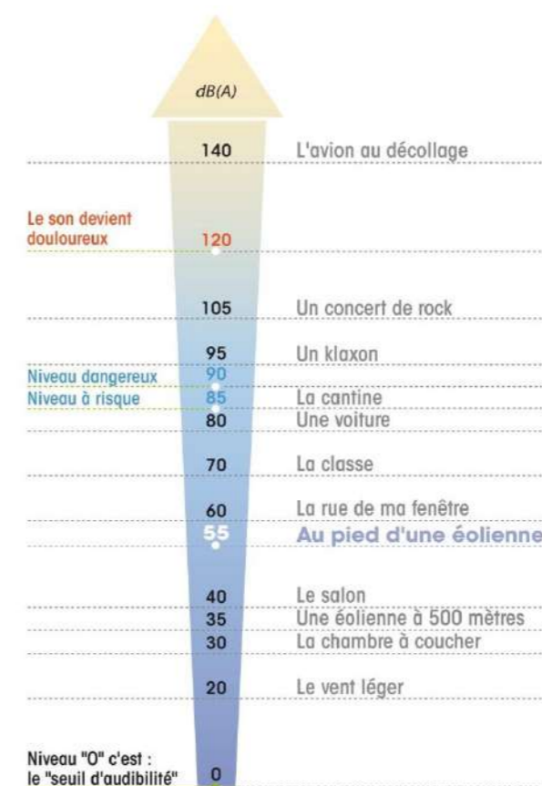
Figure 20 Echelle de bruit (Source : France Energie Eolienne)
